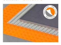
Schlüter-DITRA-PS è una guaina da interno in polipropilene, strutturata a quadratini cavi a coda di rondine e con innovativa geometria "Easyfill", rivestita sul retro con un tessuto non tessuto autoadesivo. La guaina è impermeabile all'acqua. Dopo avere rimosso la pellicola protettiva, è possibile posare DITRA-PS su un supporto idoneo senza l'utilizzo di adesivo. Funge principalmente da strato di desolidarizzazione e di sfogo della pressione del vapore. (Scheda tecnica 6.7)
