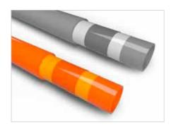
Schlüter-BEKOTEC-THERM-HR è un tubo per riscaldamento composto da 5 strati in pregiato materiale polimerico (PE-RT) con barriera all'ossigeno integrata. Il tubo da riscaldamento ad elevata flessibilità e conforme alla normativa DIN 16833 è stato specificamente concepito per l'uso con i pannelli del sistema BEKOTEC. E' impermeabile all'ossigeno secondo norma DIN 4726. La sua qualità certificata è soggetta ad un continuo monitoraggio.
