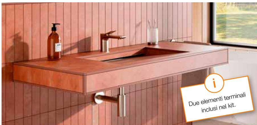
Schlüter-KERDI-BOARD-WDP è un profilo di deflusso integrato nel lavabo KERDI-BOARD-WS come fuga d'ombra. È realizzato in acciaio inossidabile V4A spazzolato. Il deflusso avviene al centro attraverso una fessura di scarico lunga 140 mm. Il profilo di deflusso viene fornito con due terminali aggiuntivi. (Scheda tecnica 12.3)
