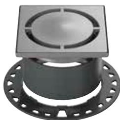
Le griglie dispongono di una prolunga e di un collare per la regolazione dell'altezza. Queste griglie non sono sifonate; il relativo sifone è integrato nel corpo di scarico.
