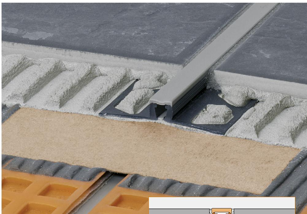
Schlüter®-DILEX-BWB viene utilizzato come giunto di dilatazione nelle pavimentazioni in ceramica posate a colla e deve essere allineato esattamente ai giunti presenti nel sottofondo. Questo tipo di giunto non è adatto per essere utilizzato in concomitanza con giunti di dilatazione strutturali.
