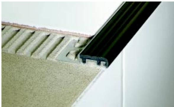
La larghezza della superficie della pedata in **Schlüter®-TREP-SE/-S** è di 26 mm e in **Schlüter®-TREP-B** è di 52 mm. Le parti di supporto comprendono una spalla di fissaggio con fori a forma trapezoidale utilizzate per l'ancoraggio del profilo.
